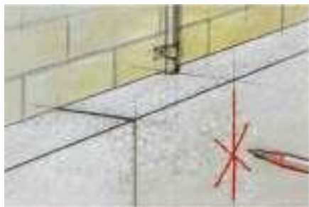
Рис. 14 - Устройство метки в местах прокладки инженерных сетей
