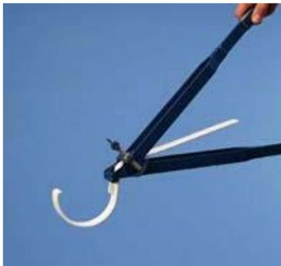
2. Согните крепежные кронштейны с помощью инструмента для сгибания. Кронштейн должен быть согнут таким образом, чтобы после сборки передний край сточного желоба был примерно на 2 мм ниже заднего.
